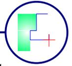
Per **disegnare un segmento proseguendo un allineamento esistente**, inserire due punti sull'oggetto che definisce l'allineamento e inserire il punto successivo vincolando l'angolo a 180 gradi.
